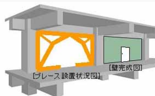
【鉄骨ブレース補強】
